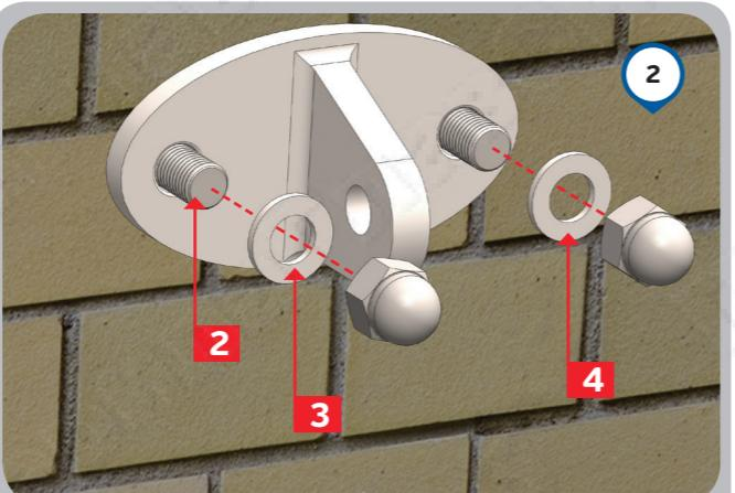
Зафиксировать фланец № 2 с помощью колпачковой гайки №4 и шайбы №3, использовать ключ на 24
