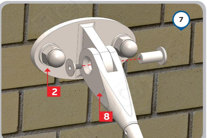
Соединить тягу № 8 (в сборе) с основанием № 2 при помощи шестигранного ключа
