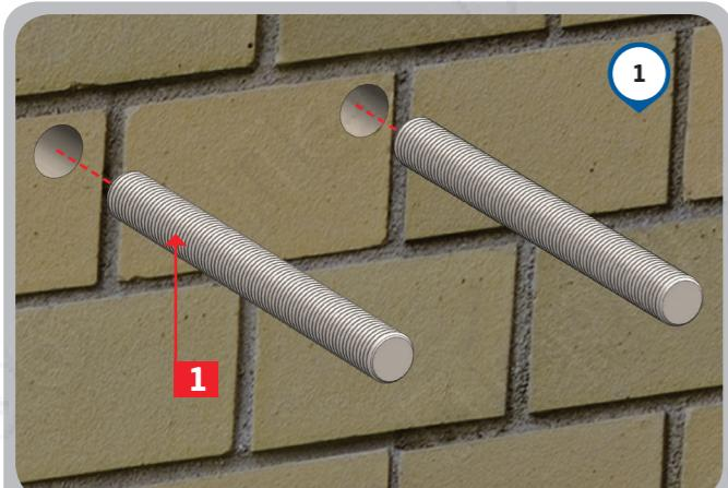
Сделать отверстия для шпильки № 1 и закрепить ее на монтажный клей
