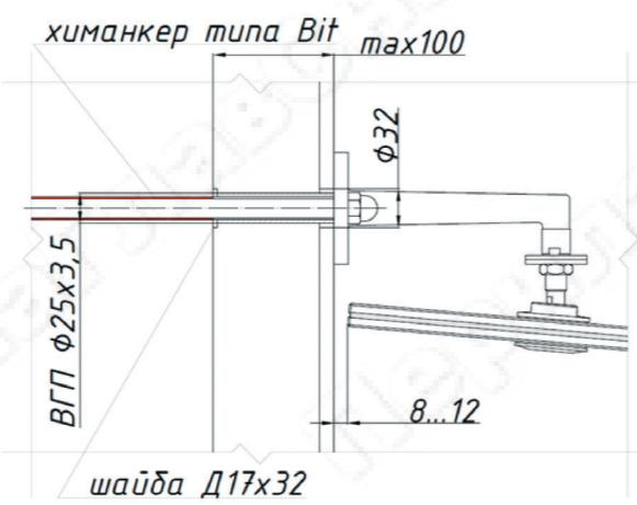
⑤ узел с использованием металлического стержня в роли несущего элемента. Это мо-жет быть шестигранник или пруток.
