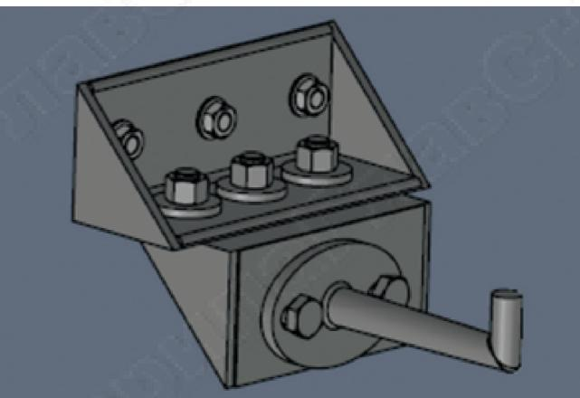
③ регулируемый по выносу и наклону за-кладной элемент для зданий с вентфасадом. Данное решение обусловлено тем, что стекло козырька нужно повесить под большим углом к фасаду.
