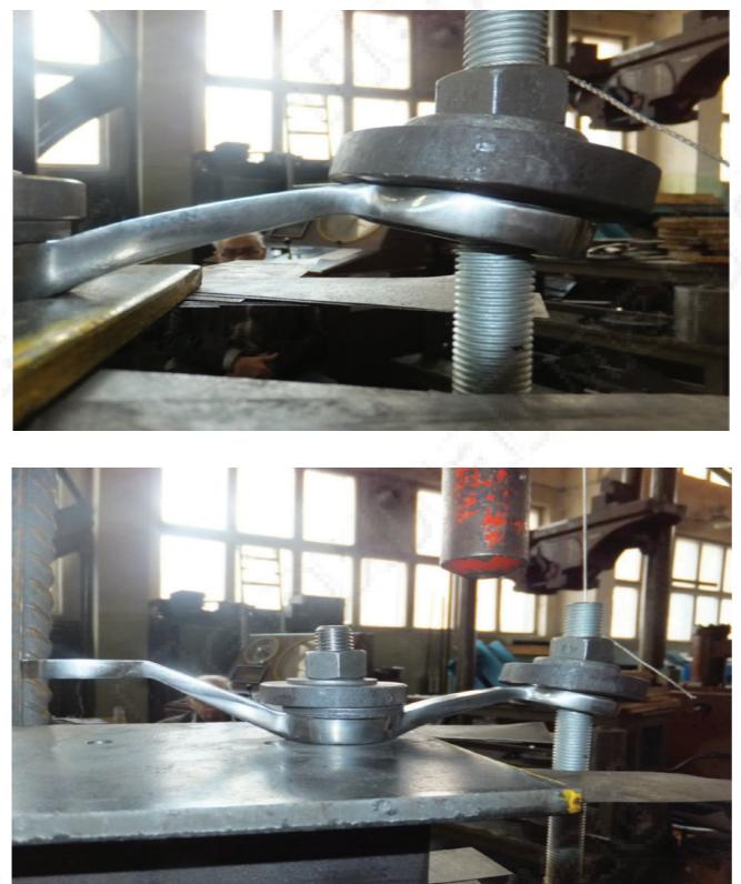
Ход экспериментов заключался в последовательном выполнении следующих операций: загрузка спайдера вертикальной силой 80 кгс, сброс нагрузки до 0, загрузка вертикальной силой 100 кгс и вновь сброс нагрузки до 0, затем с интервалом 100 кгс загрузка спайдера до 500 кгс, после чего проводили разгрузку до 0.
