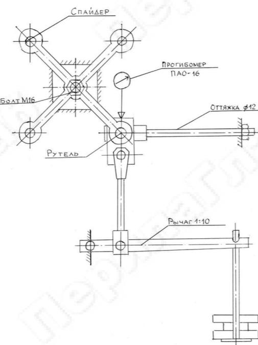
**Итог:** Анализируя полученные результаты, можно отметить, что наиболее стабильные удлинения получены при нагрузке 100 кгс. Разброс перемещений при усилиях 80 кгс объясняется тем, что эта нагрузка очень мала для реальных поперечных сечений спайдеров.
