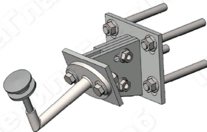
④ узел с использованием дистанцев. При-меняется для зданий с небольшим выносом вентилируемого фасада, 20-100 мм или для зданий, облицованных декоративным кир-пичом. В роли дистанцев выступает труба ВГП  $\phi 25 \times 3,5$  мм, предварительно прогрун-тovanная.
