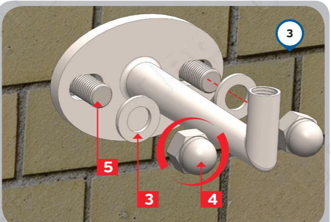
Аналогично п. 2 зафиксировать № 5 с помощью колпачковой гайки и шайбы
