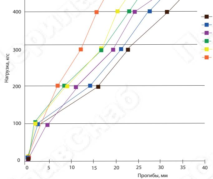
**Итог:** Прогибы, зафиксированные в этой серии экспериментов, показали, что при расчетной нагрузке 100 кгс результаты испытаний спайдеров с удлиненными консолями (спайдеры X, Y, V и Y/2) примерно в 1.5 раза выше, чем у других спайдеров. Эта же разница в целом сохранилась и при вертикальной силе 500 кгс.
