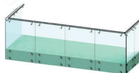
Тип 3 - ограждение балкона без стоек, стекло установлено в торец несущей плиты. Поручень на выносах, кромки стекла открыты.
