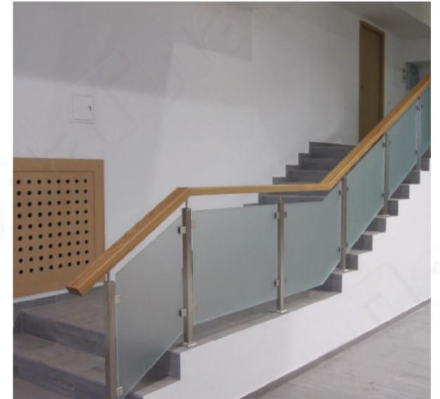
Ограждение с деревянным поручнем цвета «натур» и сечением 40x80 мм на квадратных стойках 40x40 мм и матовым стеклом. Крышка фланца стойки трапецевидная k064.
