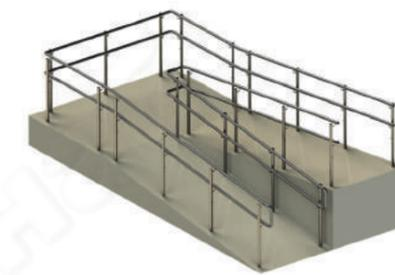
Пандус «П-образный», с разворотом на 180 градусов и площадью 1.5 кв.м., функцию нижнего ограничителя выполняет бетонный парапет по ГОСТ (50 мм высоты, не показан на чертеже).
