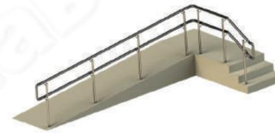
Пандус «Г-образный», функцию нижнего ограничителя выполняет бетонный парапет по ГОСТ (50 мм высоты, не показан на схеме).
