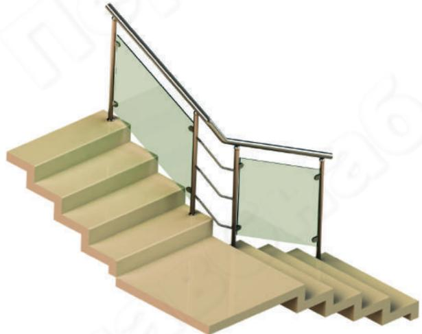
Ограждение колодезной лестницы со стеклом и завязками на поворотах.
