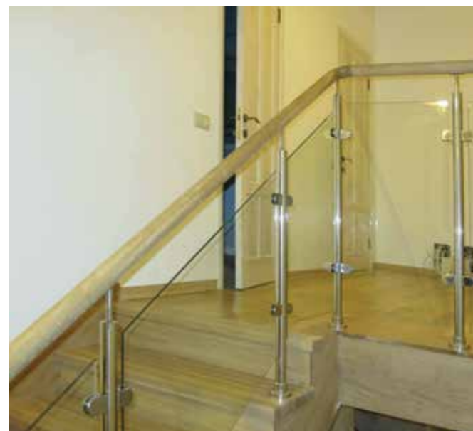
Ограждение с деревянным поручнем цвета «натур». Крепление стойки цангой k026, специально разработано для установки стойки сверху в деревянные ступени. Наконечник k006.
