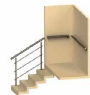
Пристенный поручень прерывается на поворотах.
