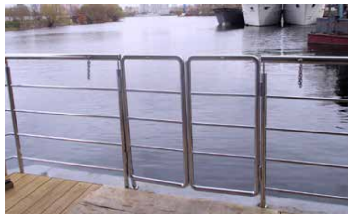
Катамаран серии ТМ-20 плавучий дом. Среди выполненных работ: леера кормовой части первой палубы с калитками и леера надстройки, кранбалки с лебедками на корме, декоративные трубы дымохода (надстройки), трап и леера с левой палубы на надстройку из нержавеющей стали.
