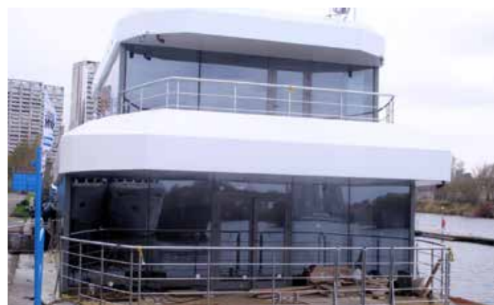
Катамаран серии ТМ-20 плавучий дом. Среди выполненных работ: леера кормовой части первой палубы с калитками и леера надстройки, кранбалки с лебедками на корме, декоративные трубы дымохода (надстройки), трап и леера с левой палубы на надстройку из нержавеющей стали.
