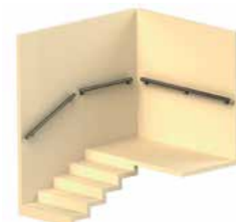
Пристенный поручень развязан в углах.
