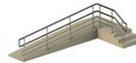
Пандус «Г-образный» с входной группой, окончание двух поручней и двух ригелей соединены между собой.
