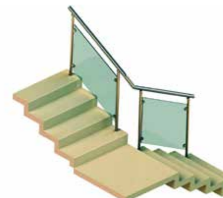
Поручень завязан, просвет между стойками не закрыт.
