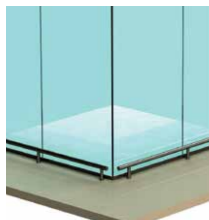
Отбойник развязан на углах.
