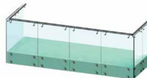
Тип 2 - ограждение балкона без стоек, стекло установлено в торец несущей плиты. Поручень монтируется сверху на стекло.
