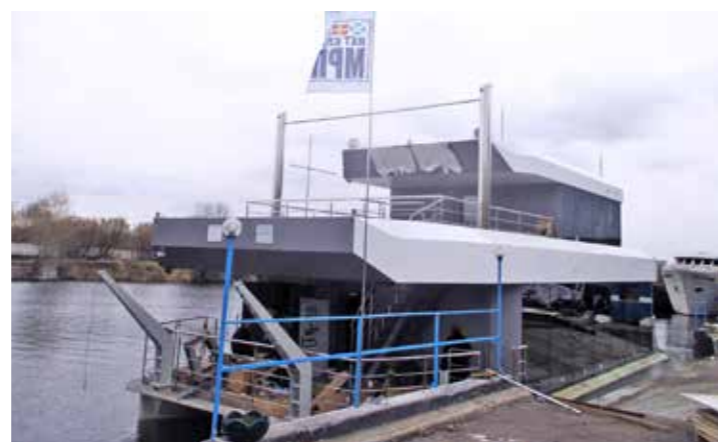
Катамаран серии ТМ-20 плавучий дом. Среди выполненных работ: леера кормовой части первой палубы с калитками и леера надстройки, кранбалки с лебедками на корме, декоративные трубы дымохода (надстройки), трап и леера с левой палубы на надстройку из нержавеющей стали.
