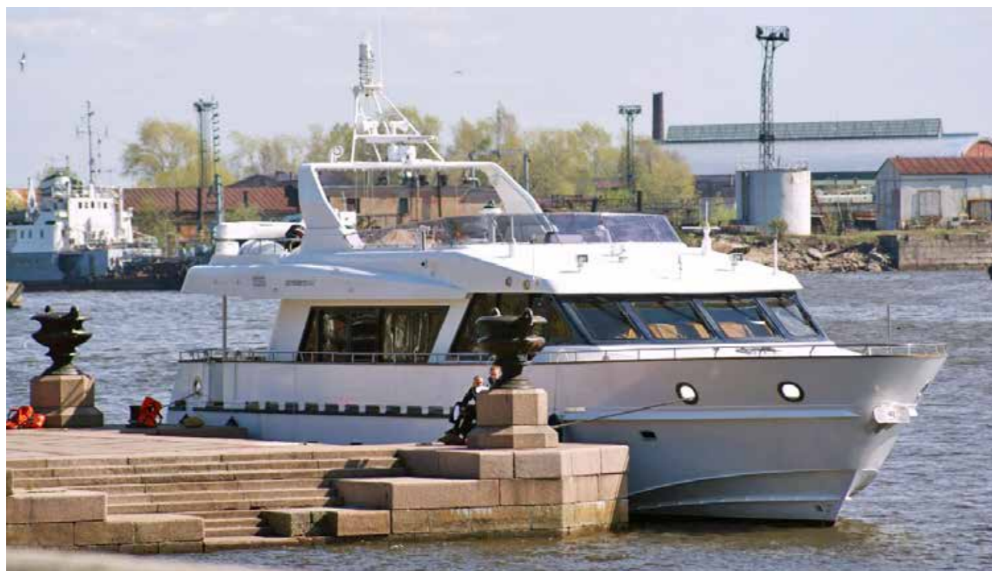
Адмиралтейский катер, на котором принимал парад ВМФ Президент России Владимир Владимирович Путин. Выполнены леера кормовые, носовые, по бортам, леера рулевой рубки, ветрозащитный экран и вспомогательные леера во внутренних помещениях. Конструкция экрана состоит из нержавеющей трубы с заполнением монолитным поликарбонатом.
