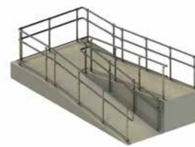
Пандус «П-образный», функцию нижнего ограничителя выполняет один ригель д.16 мм, установленный на высоте 50 мм от уровня пандуса.
