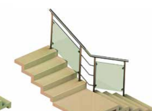
Поручень завязан, просвет между стойками закрыт тремя ригелями.
