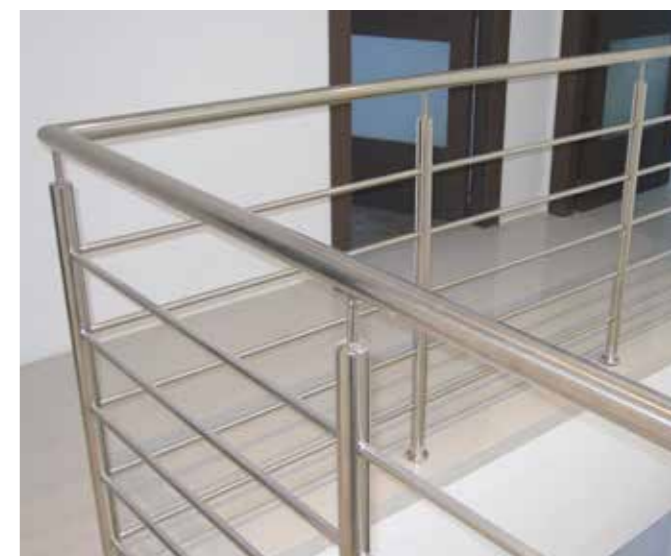
Поворот ограждения, выполненный одной стойкой, пять ригелей диаметром 16 мм проходят сквозь стойку. Наконечники k006, крышка основания стойки средняя.
