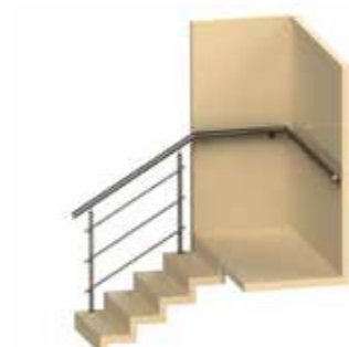
Пристенный поручень непрерывный, переходящий на ограждение лестницы.
