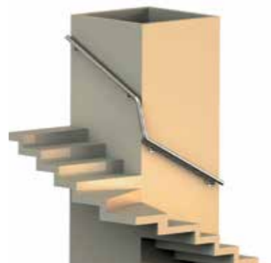
Поручень вокруг стены завязан по диагонали для компенсации перепада забежных ступеней.
