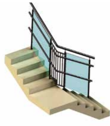
Ограждения со стойками и стеклом 8 мм. На повороте вертикальное заполнение нержавеющей сталью.
