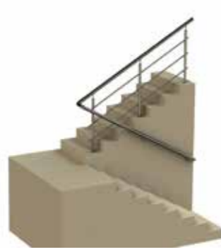
Пристенный поручень завязан с основным ограждением.
