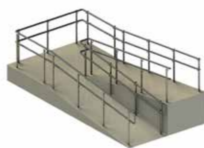
Пандус «П-образный», с разворотом на 180 градусов и площадкой площадью 1.5 кв.м., функцию нижнего ограничителя выполняет бетонный парапет по ГОСТ (50 мм высоты, не показан на чертеже).
