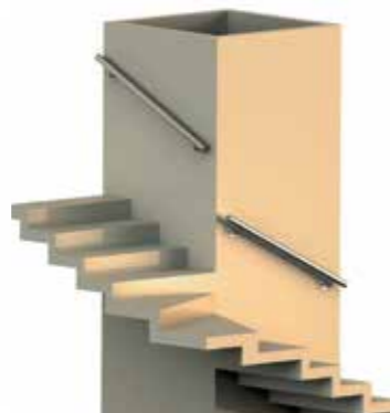
Пристенный поручень вокруг шахты лифта не завязан на повороте.
