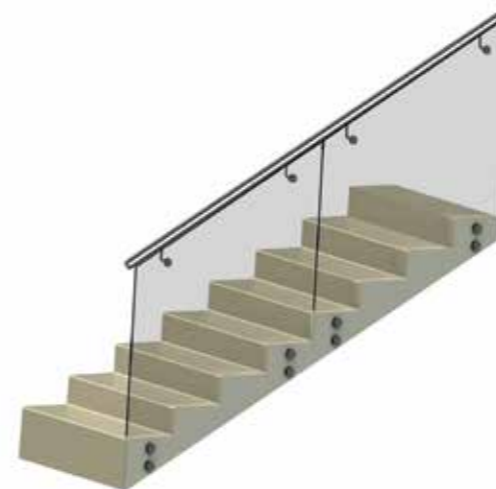
Боковой крепеж несущего стекла на точечных держателях.
