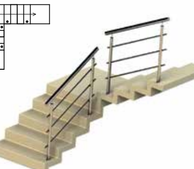
Ограждения колодезной лестницы, поручень и ригели не завязаны на поворотах.
