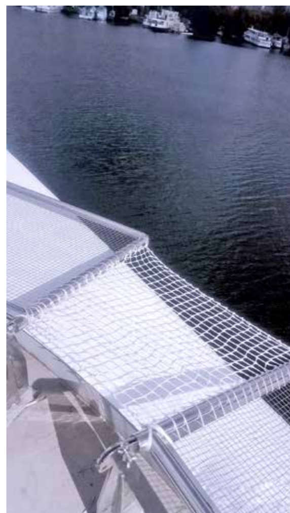
Откидные ограждения вертолетной площадки. Секции из полированной нержавеющей стали Ф42х2 мм, заполнение секции тканая сетка. Стойки в местах крепления к палубе снабжены стопроно-откидным механизмом, который позволят фиксировать ограждение в 3-х положениях.
