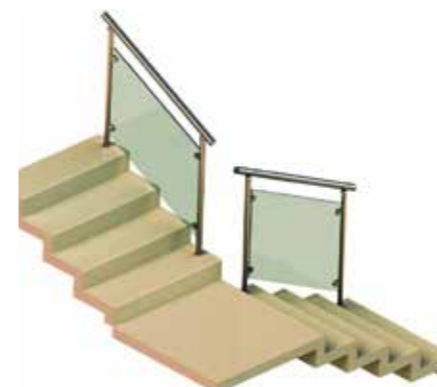
Поручень развязан, просвет не закрыт. Самый экономичный вариант для ограждений со стеклом.
