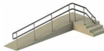
Пандус «Г-образный», функцию нижнего ограничителя выполняет бетонный парапет по ГОСТ (50 мм высоты, не показан на схеме).
