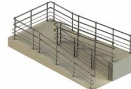
Пандус «П-образный», функцию ограничителя выполняют 2 ригеля д.16 мм, соединенные между собой в начале и в конце линии ограждения.
