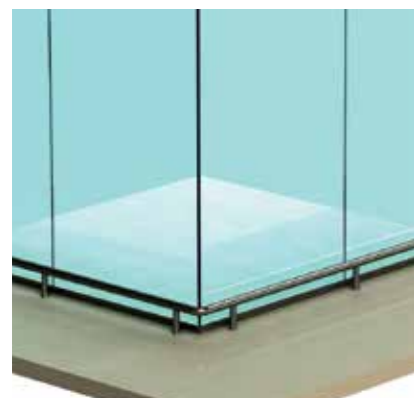
Колесоотбойник защищающий стеклянную витрину от ударов тележек, отбойник завязан на углах.
