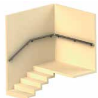
Пристенный поручень завязан в углах для большей жесткости.
